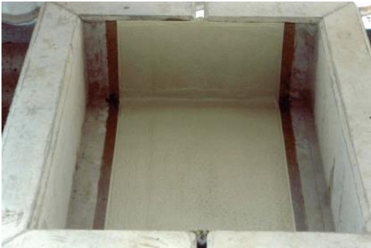
Prüfgefäß mit durchgängiger, ca. 3 cm breiter Fuge
