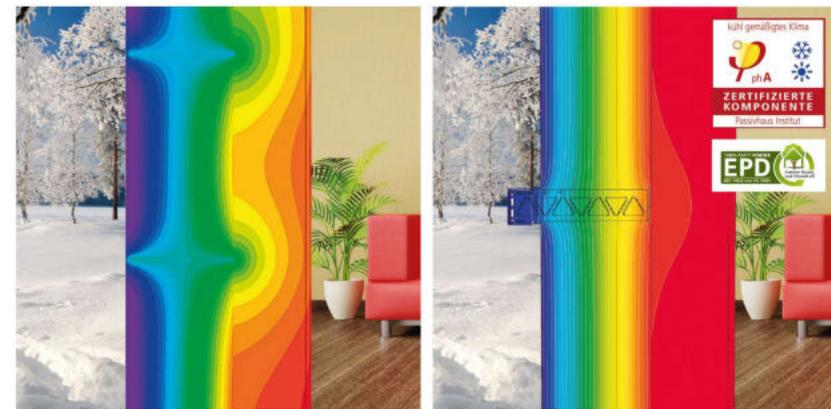
Abb. 1: Ausgeprägte Wärmebrücke bei Aluminiumkonsolen
